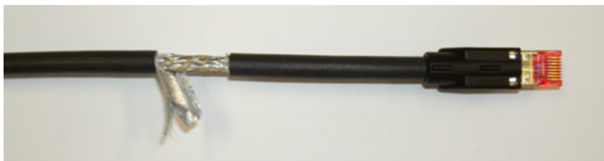
Abb. 10-14: Folienschirm des CDI-Kabels
